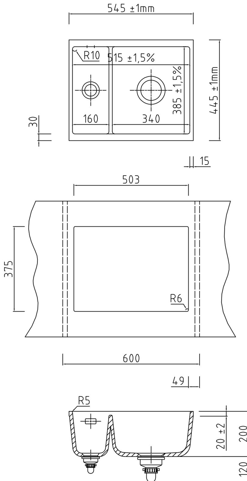
Wir empfehlen, aufgrund der werkstoffbedingten Toleranzen von +/- 1,5% den Ausschnitt anhand des gelieferten Beckens zu fertigen.
